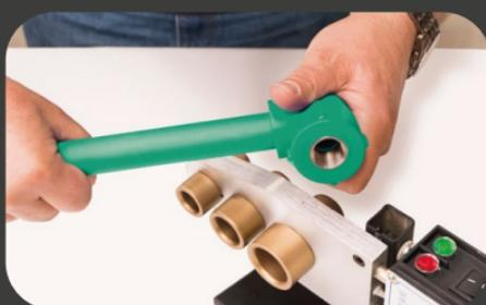
Caliente simultáneamente en el termofusor las partes a unir hasta que haya cumplido los tiempos de calentamiento (T1) indicados en la tabla No.2.
